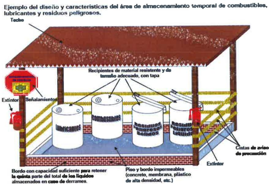
Figura 1. Prototipo de caseta para residuos peligrosos
