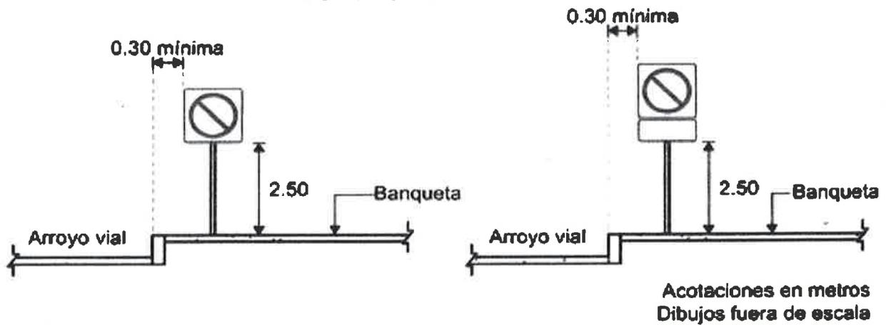
FIGURA 2.- Distancia lateral y altura de las señales restrictivas.
