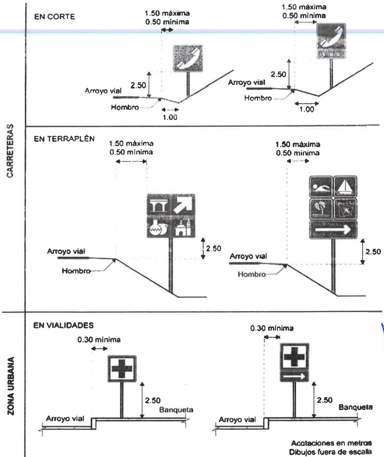
FIGURA 3.- Distancia lateral y altura de las señales turísticas y de servicios.
