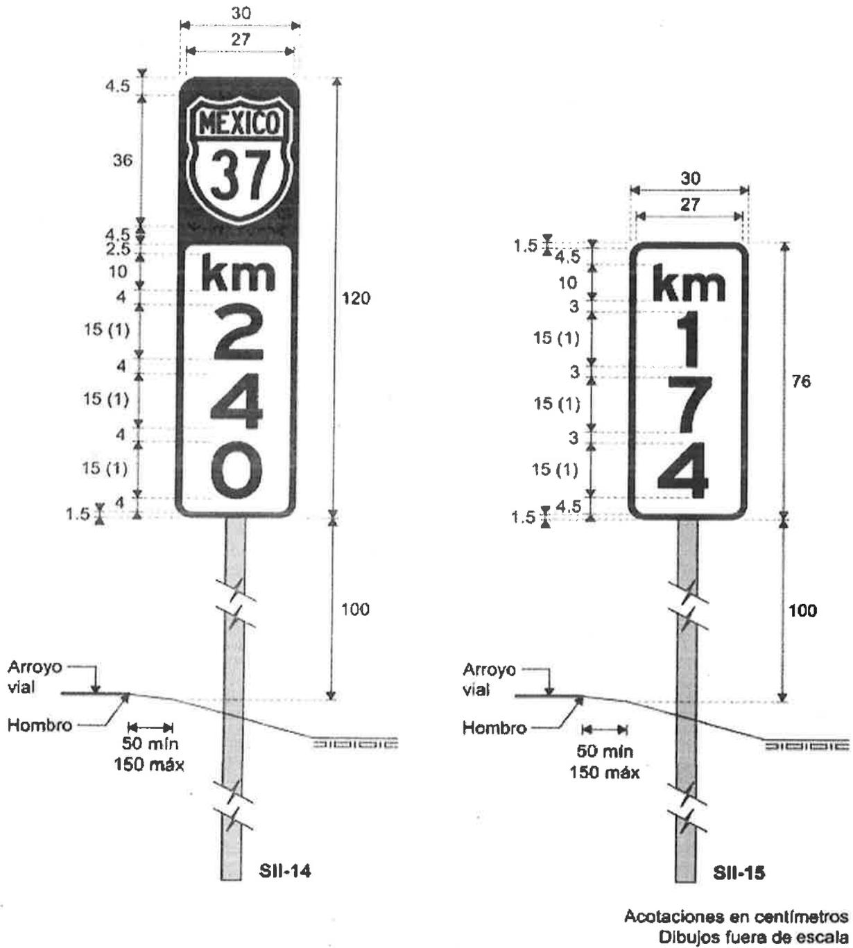
FIGURA 5.- Distancia lateral y altura de las señales de kilometraje y ruta.
