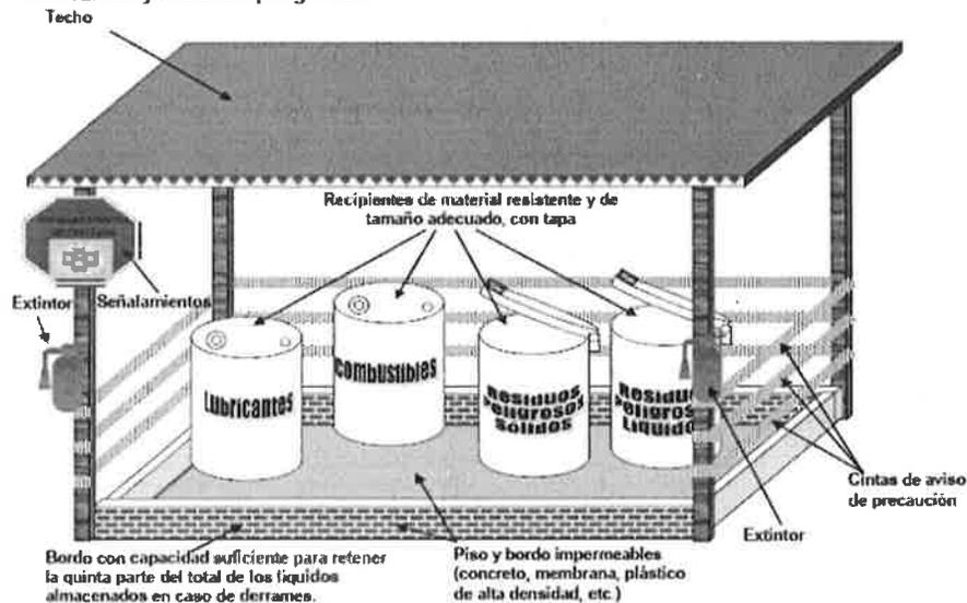
Figura 1. Prototipo de caseta para residuos peligrosos
