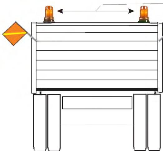
Torretas Estroboscópica Montaje fijo de 24 VCD dimensiones 7"x 6" (Color ámbar)
