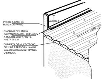
01 DETALLE DE CUBIERTA DE MULTYTECHO Y FLASHING
