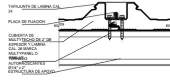
03 FIJACION DE MULTYTECHO A ESTRUCTURA
