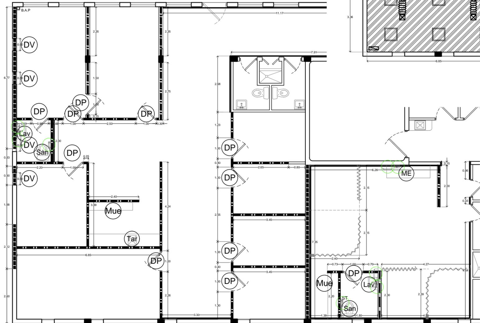
**PLANTA DE DEMOLICIONES DE MUROS Y MUEBLES**
