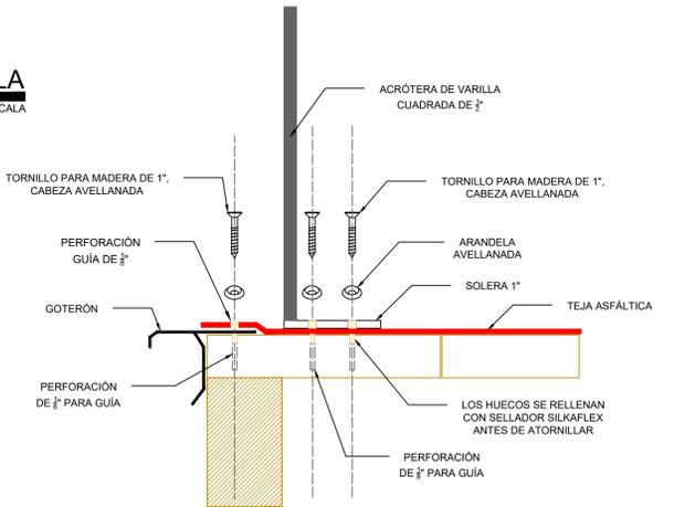
**DETALLE DE FIJACIÓN DE ACRÓTERA Y GOTERÓN**
