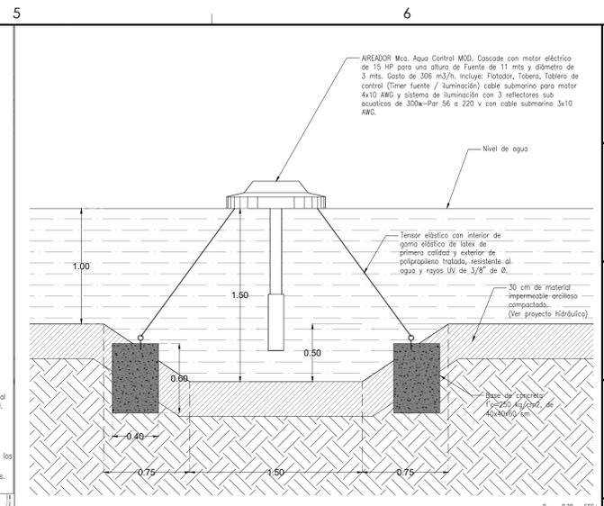
**ST-01, FIJACIÓN DE AIREADOR / SECCIÓN TIPO**
