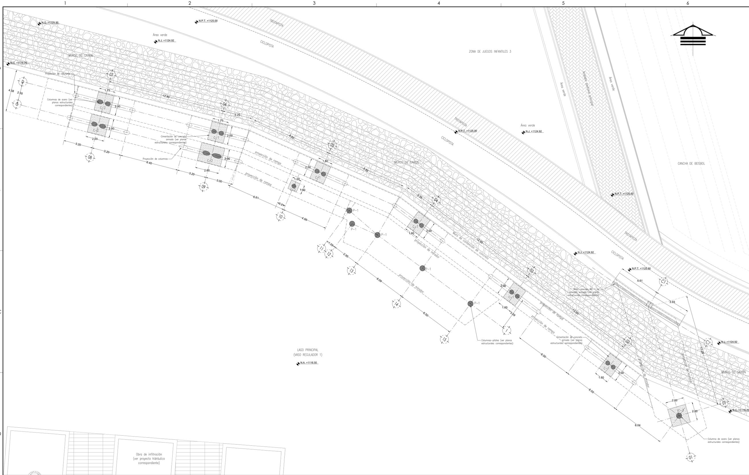
MIRADOR - EMBARCADERO / PLANTA DE DESPLANTE DE CIMENTACIÓN
