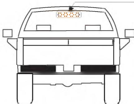
1 Barra de luces LED con 8 módulos ámbar destellantes
