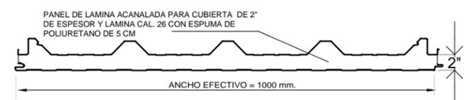
**02 DETALLE DE PLACA DE CUBIERTA**
