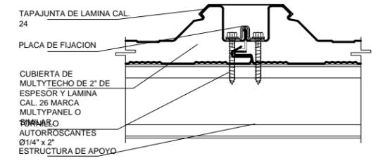
**03 FIJACION DE MULTYTECHO A ESTRUCTURA**
