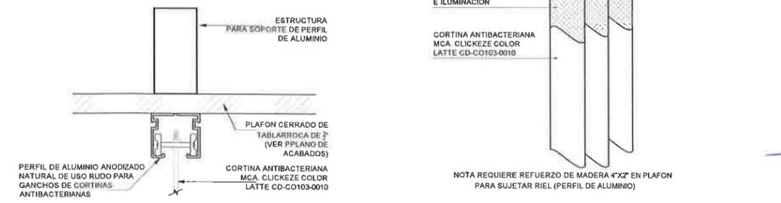
NOTA REQUIERE REFUERZO DE MADERA 4"X2" EN PLAFON PARA SUJETAR RIEL (PERFIL DE ALUMINIO)
