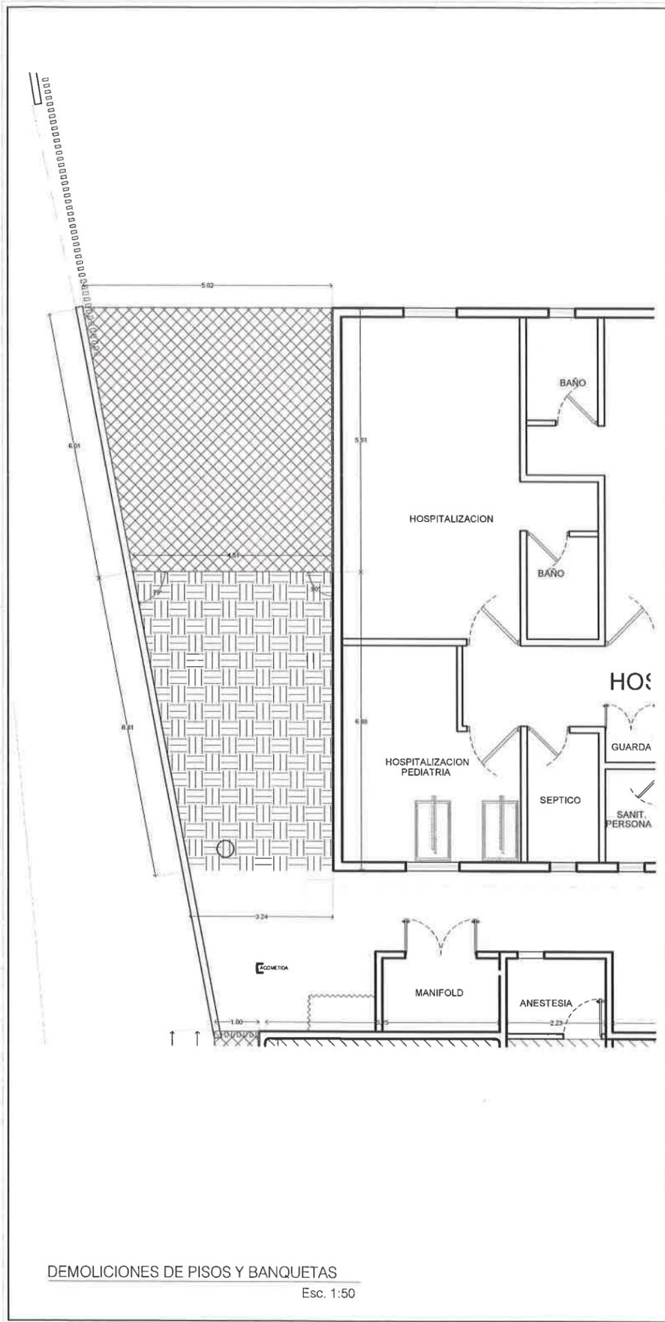
DEMOLICIONES DE PISOS Y BANQUETAS
