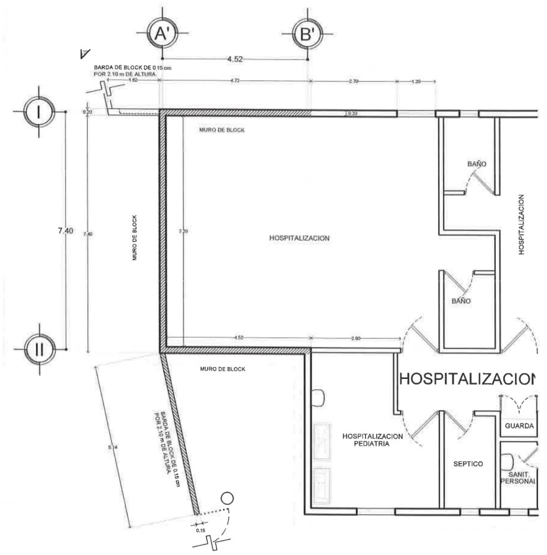
PLANTA DE ALBAÑILERÍA
