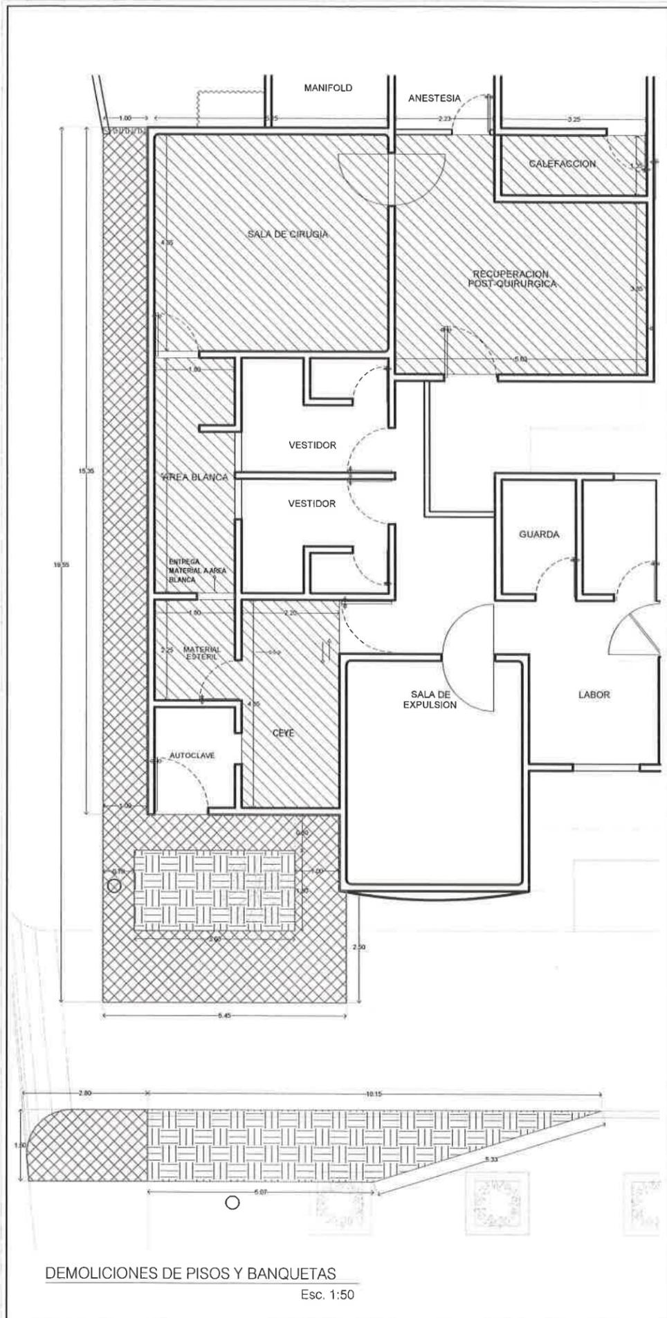
DEMOLICIONES DE PISOS Y BANQUETAS
