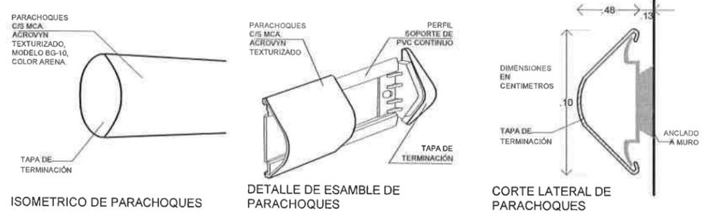
DETALLE DE SISTEMA DE PROTECCIÓN EN MUROS
