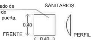
Señalamiento de PVC con soportería de aluminio rotulado con vinil en acabado metálico, colocado por la parte frontal.
