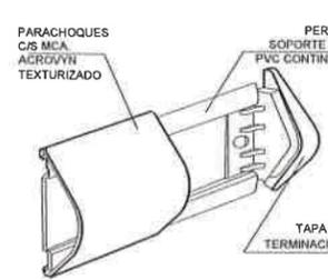
DETALLE DE ENSAMBLE DE PARACHOQUES
