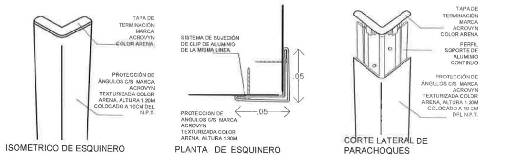
DETALLE SISTEMA DE PROTECCIÓN EN EQUINAS
